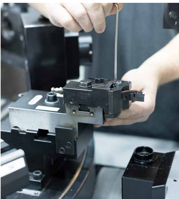
Komfortable Werkzeugvoreinstellung außerhalb der Maschine.
